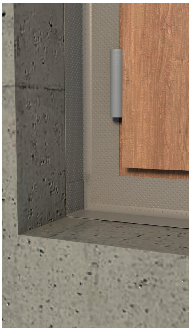
Calfeutrement par l'intérieur d'une menuiserie avec membrane TRAMIFLEX OPTIMA VARIO
